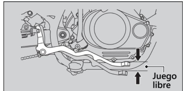
Asegúrese de que la varilla del freno, el brazo del freno, el muelle y el dispositivo de sujeción estén en buenas condiciones.
