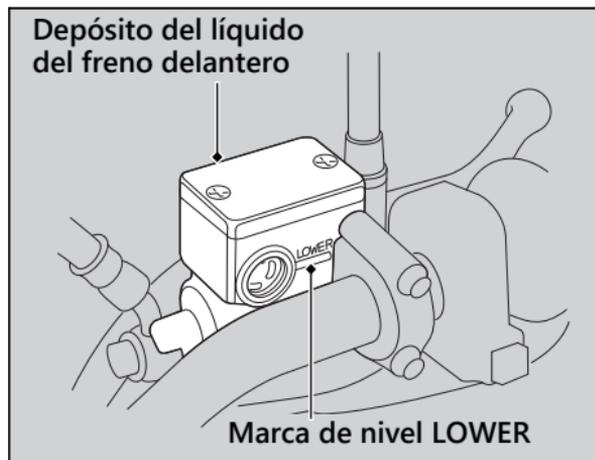
Si el nivel del líquido de frenos del depósito queda por debajo de la marca de nivel LOWER o el juego libre en la maneta del freno llega a ser excesivo, inspeccione el desgaste de las pastillas de freno.
