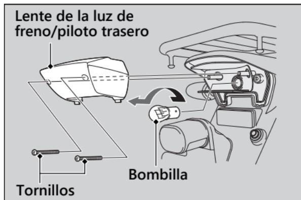
1. Extraiga la lente de la luz de freno/piloto trasero extrayendo los tornillos.
