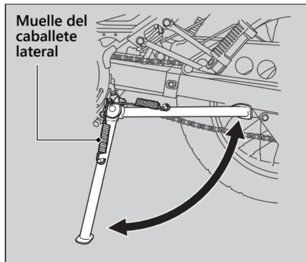
1. Compruebe que el caballate lateral funciona debidamente. Si el caballate lateral resulta difícil de colocar o chirría, limpie la zona de giro y lubrique el perno de giro con grasa limpia.
