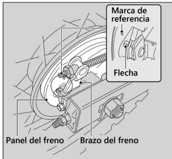
Cuando se acciona el freno, la flecha unida al brazo del freno se mueve hacia una marca de referencia en el panel del freno. Si la flecha se alinea con la marca de referencia al accionar el freno a fondo, es necesario reemplazar las zapatas de freno.
