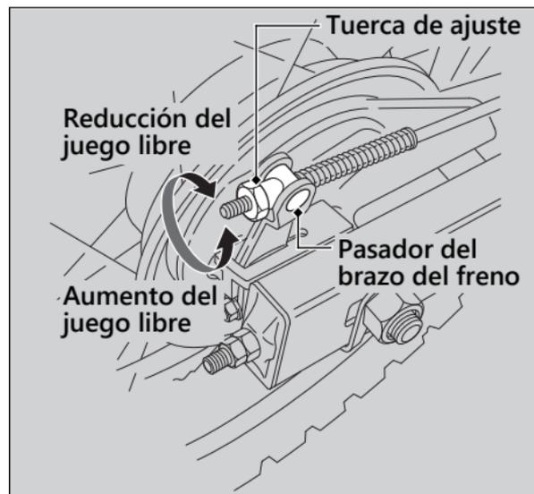
1. Realice el ajuste girando la tuerca de ajuste del freno trasero media vuelta cada vez.
