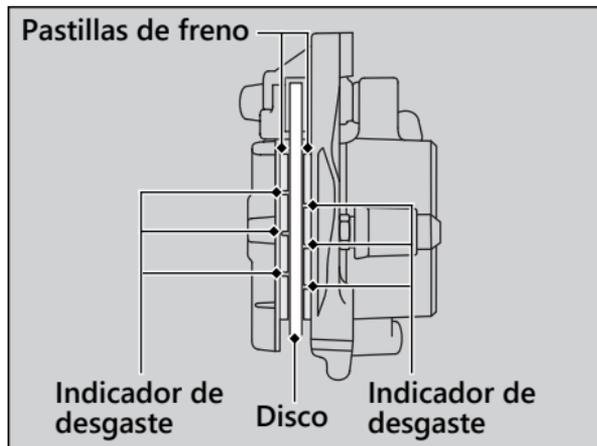
1. Inspeccione las pastillas de freno desde la parte frontal de la pinza de freno.
